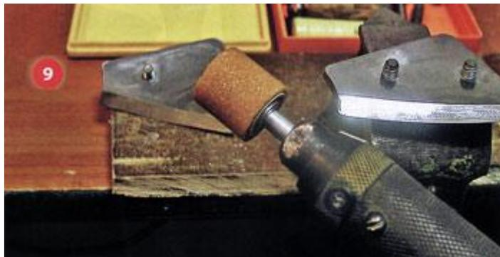
Важно выполнять совершенно однообразное движение напильником на себя, с одновременным изменением угла наклона напильника. Если довести это движение до автоматизма, то сам процесс заточки занимает несколько минут. Чтобы четко контролировать обрабатываемую поверхность, можно несколько изменять направление движения абразива. Риски на поверхности лезвия дают полную картину. Критерий остроты заточки аналогичен вышеописанному.
